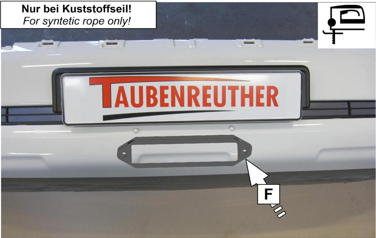
**Bei Verwendung eines Aluminiumseilfensters Außenkontur des Adapters (F) anzeichnen und ausschneiden!**
