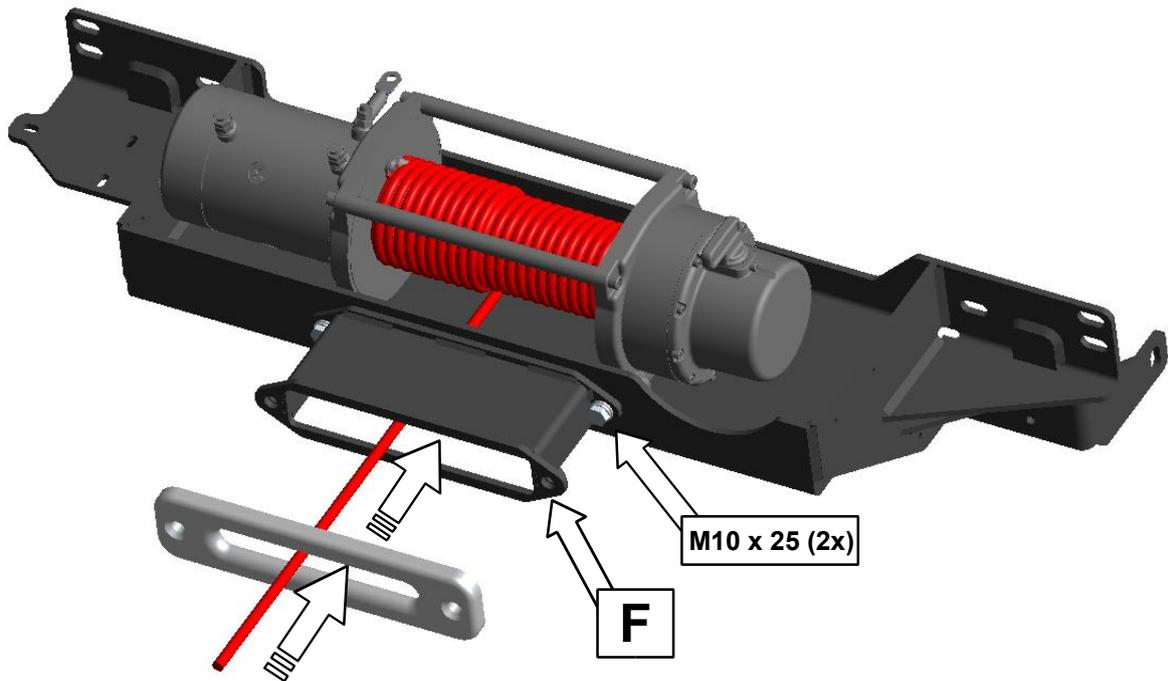
**Adapter (F) befestigen und Seil zur Hälfte aufspulen! Seilfenster noch nicht montieren, nur das Seil durchführen!**
