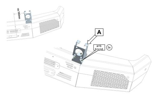
Anzeichnen, bohren (Ø 6,5 mm) und verschrauben!
