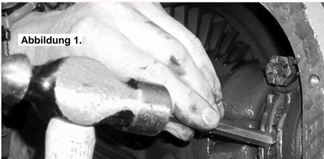
**HINWEIS:** Empfehlenswert ist, auf der linken Seite des linken Lagerdeckels **EINE** Markierung und an entsprechender Stelle am Gehäuse ebenfalls **EINE** Markierung zu setzen. Analog dazu werden die rechte Seite des rechten Lagerdeckels und die entsprechende Stelle des Gehäuses mit **ZWEI** Markierungen versehen.
